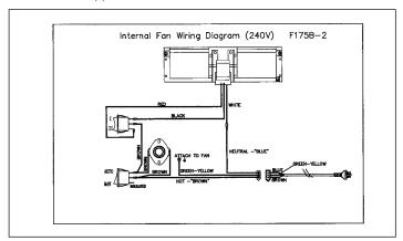
Diagram 2 - Fan Wiring Diagram
